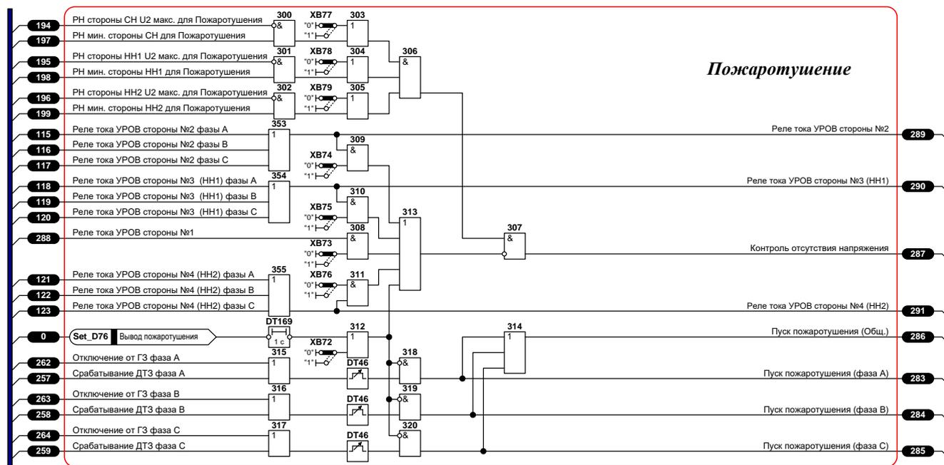
Рисунок 14 – Функциональная логическая схема блока логики пуск пожаротушения
