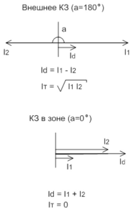
Рисунок 20 – Определение дифференциального и тормозного токов ДТЗ
