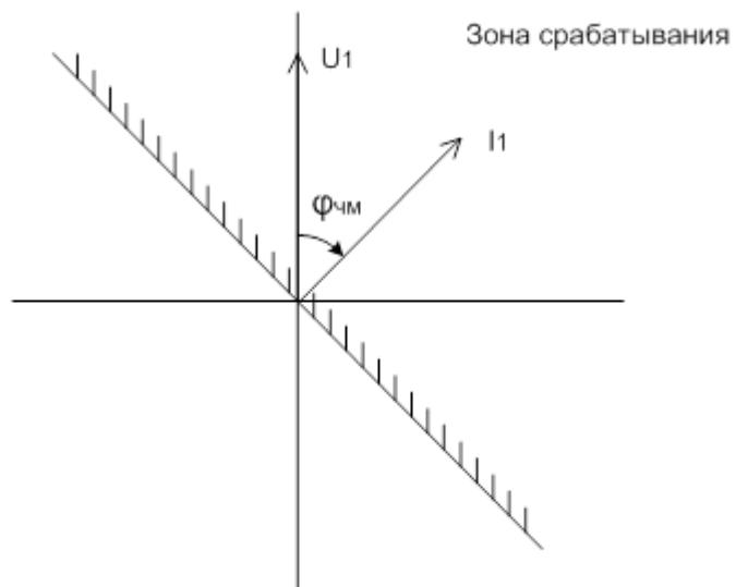
Рисунок 21 – Характеристика срабатывания РХМ МТ3 СН (HH1, HH2)
