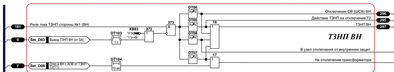
Рисунок 7 – Функциональная логическая схема блока логики ТЗНП ВН
