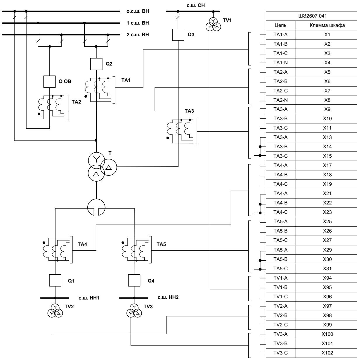
Рисунок 18 а – Схема подключения шкафа ШЭ2607 041 (ШЭ2607 041041) для одно из комплекта 01(02) к цепям переменного тока и напряжения
