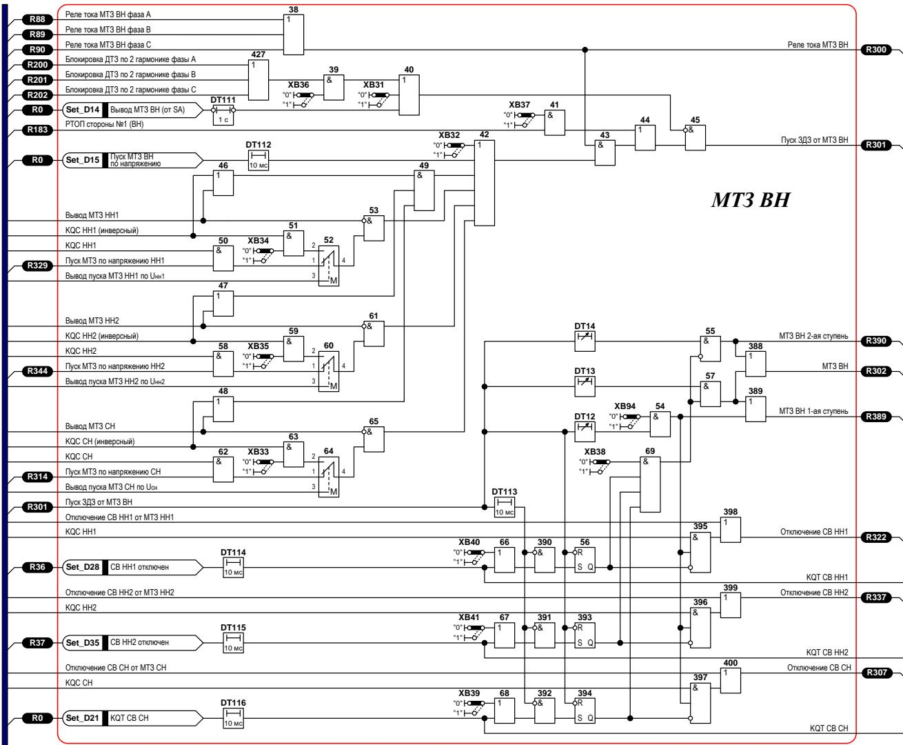
Рисунок 3 – Функциональная логическая схема блока логики MT3 BH
