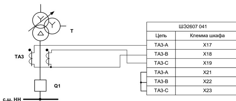
Рисунок 18 г – Схема подключения шкафа ШЭ2607 041 (ШЭ2607 041041) для одно из комплекта 01(02) к цепям переменного тока НН1 по схеме «неполная звезда»
