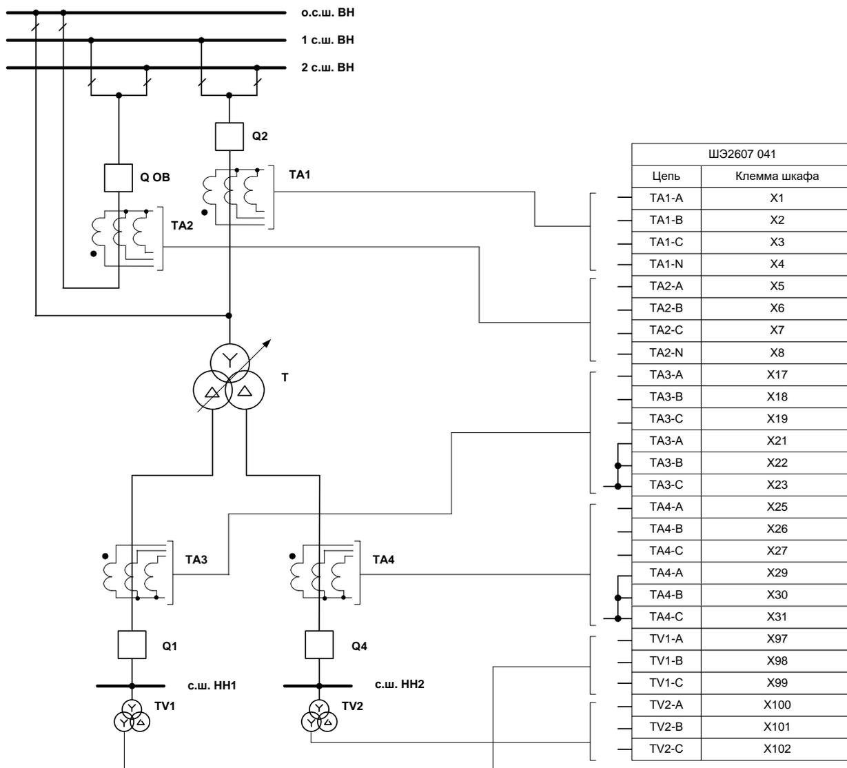
Рисунок 18 б – Схема подключения шкафа ШЭ2607 041 (ШЭ2607 041041) для одно из комплекта 01(02) к цепям переменного тока и напряжения
