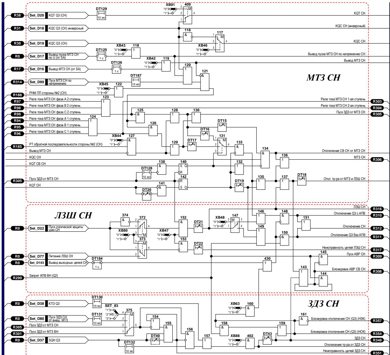
Рисунок 4 – Функциональная логическая схема блока логики МТЗ CH, LZSH CH, ЗДЗ CH
