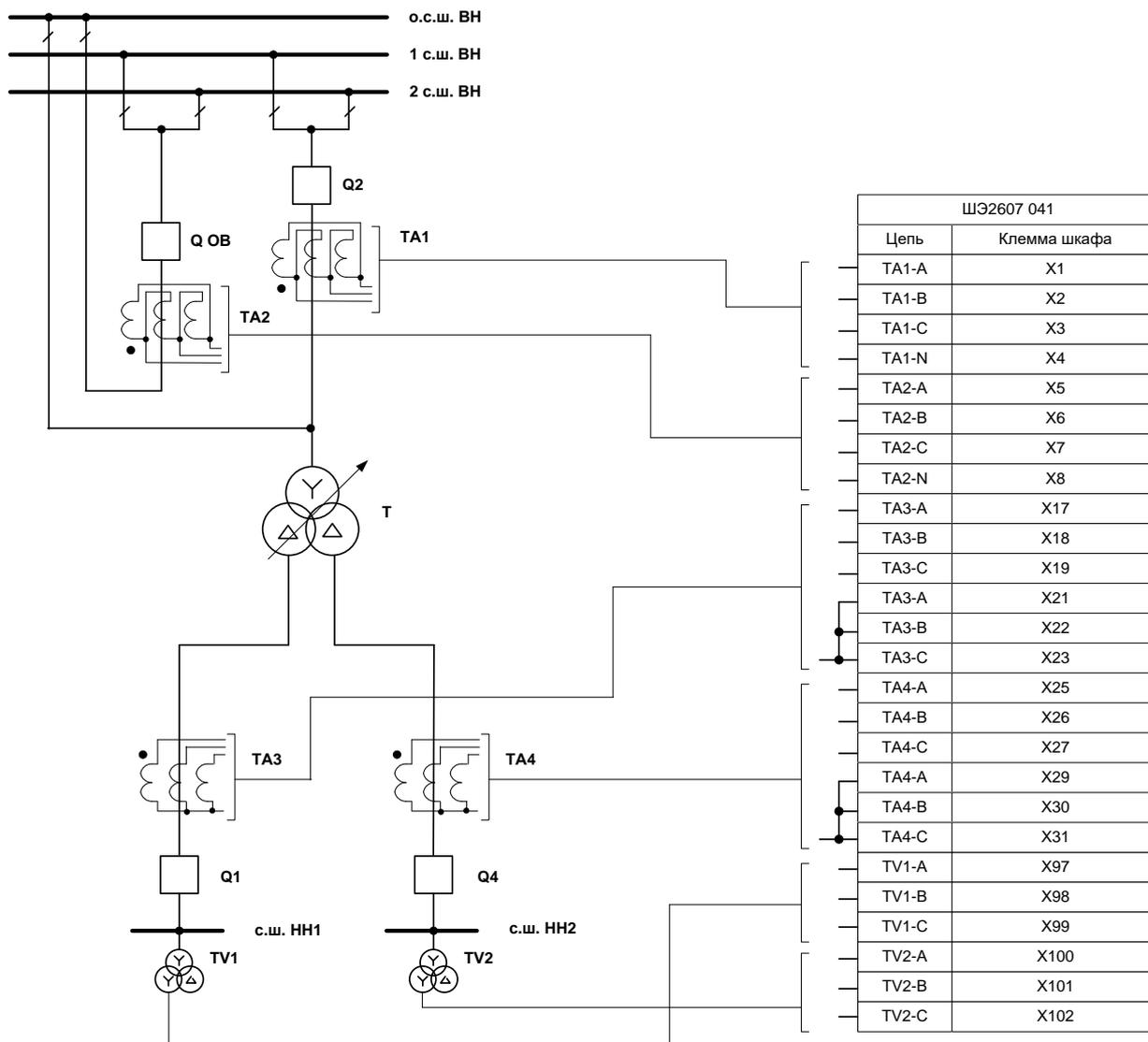
Рисунок 18 в – Схема подключения шкафа ШЭ2607 041 (ШЭ2607 041041) для одно из комплекта 01(02) к цепям переменного тока и напряжения
