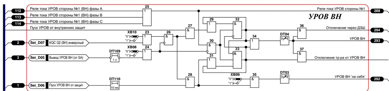
Рисунок 13 – Функциональная логическая схема блока логики УРОВ ВН
