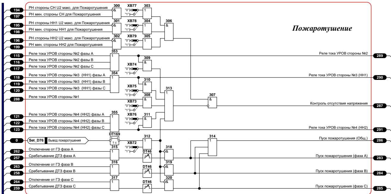
Рисунок 14 – Функциональная логическая схема блока логики пуска пожаротушения
