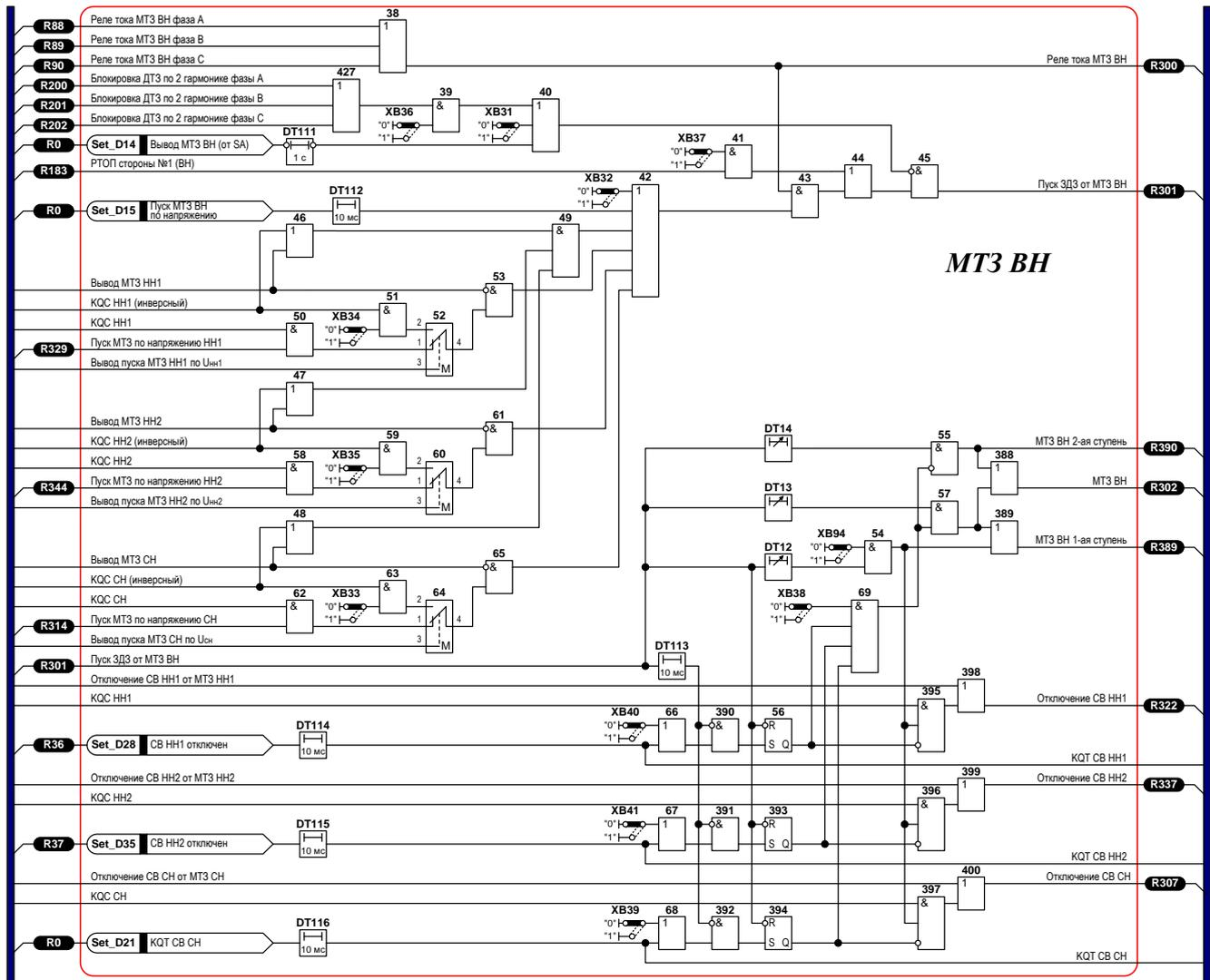
Рисунок 3 – Функциональная логическая схема блока логики MT3 ВН
