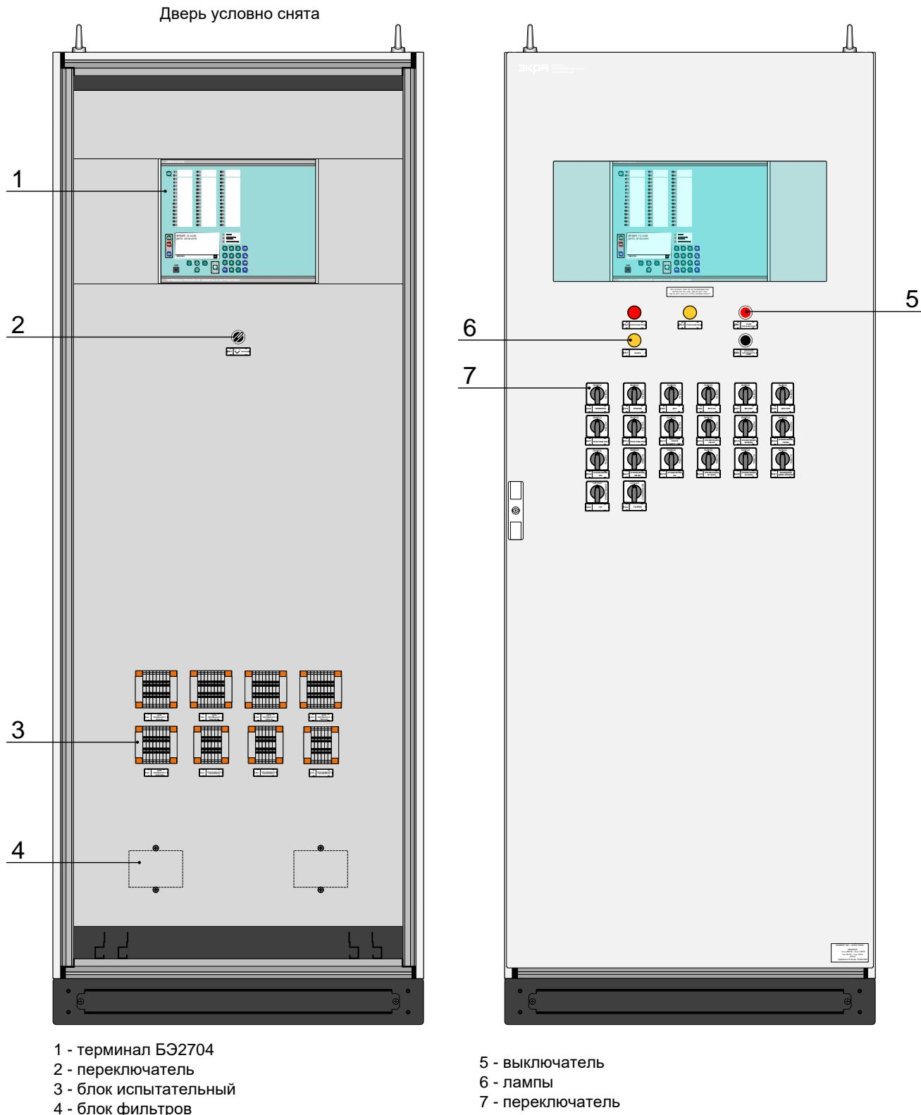
Рисунок 23 – Общий вид шкафа типа ШЭ2607 041
