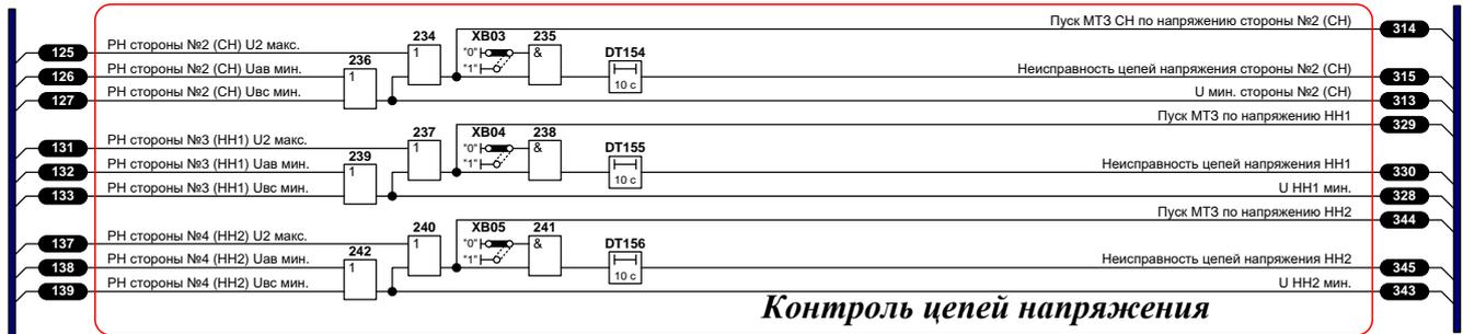
Рисунок 8 – Функциональная логическая схема блока логики контроля цепей напряжения
