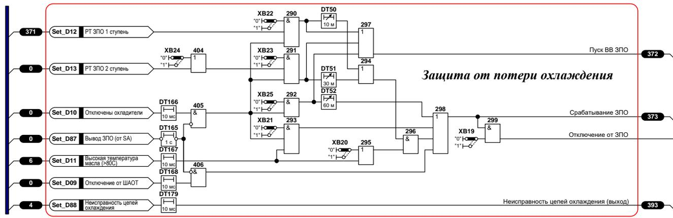
Рисунок 15 – Функциональная логическая схема блока логики ЗПО
