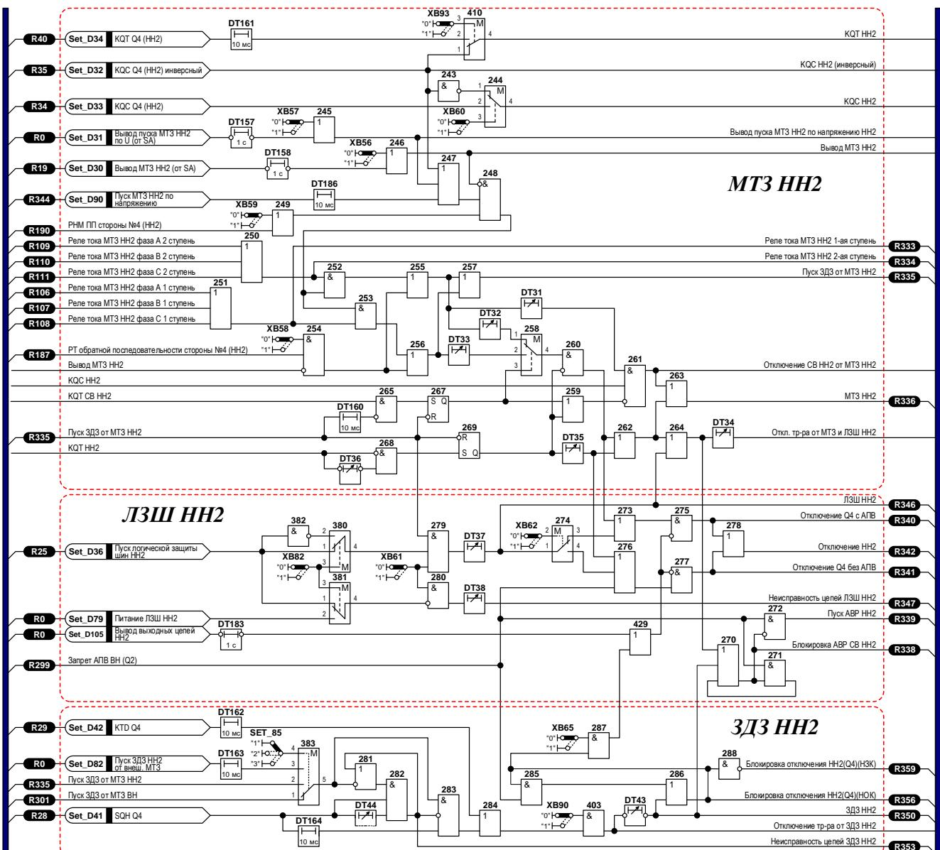
Рисунок 6 – Функциональная логическая схема блока логики MT3 НН2, ЛЗШ НН2, ЗДЗ НН2
