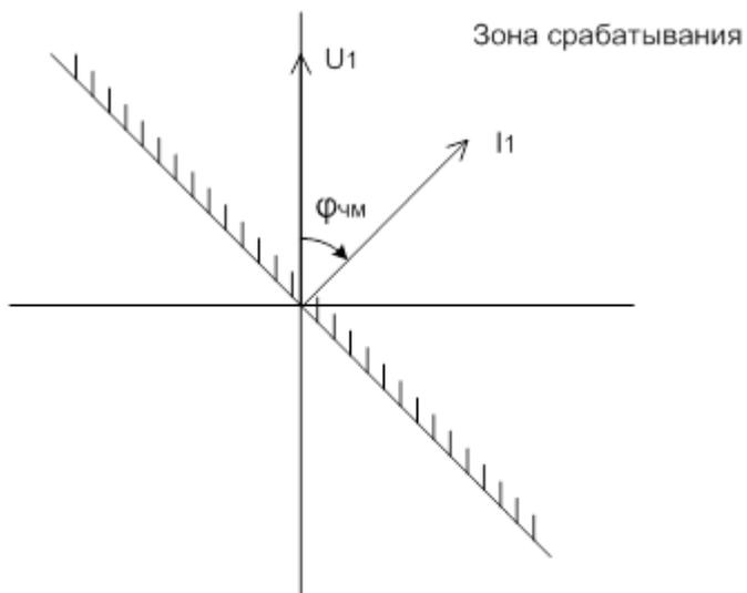
Рисунок 21 – Характеристика срабатывания РНМ МТЗ СН (НН1, НН2)
