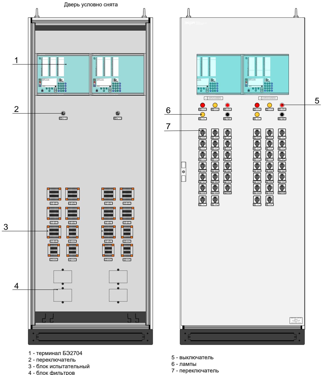
Рисунок 24 – Общий вид шкафа типа ШЭ2607 041041
