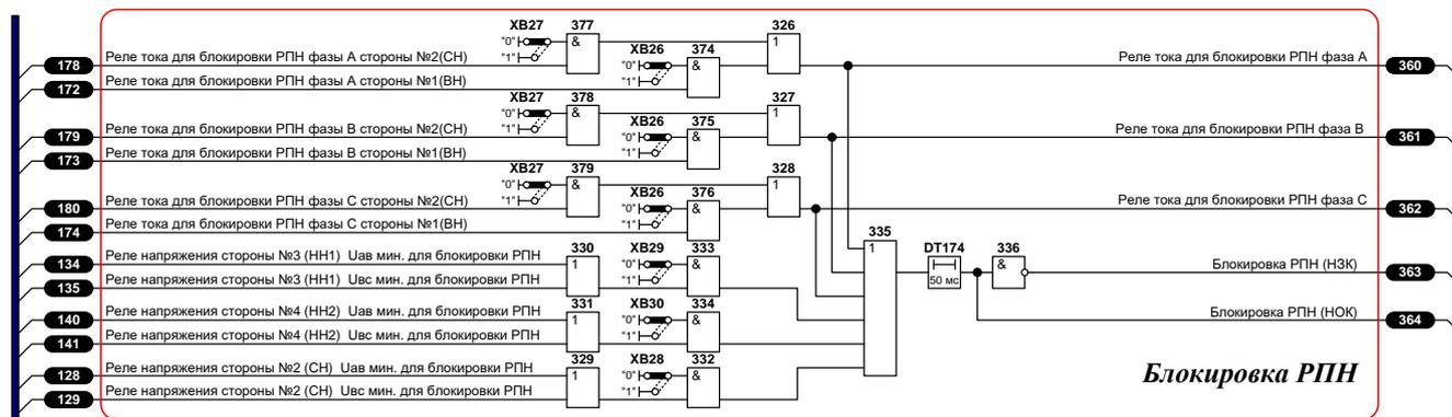
Рисунок 11 – Функциональная логическая схема блока логики блокировки РПН
