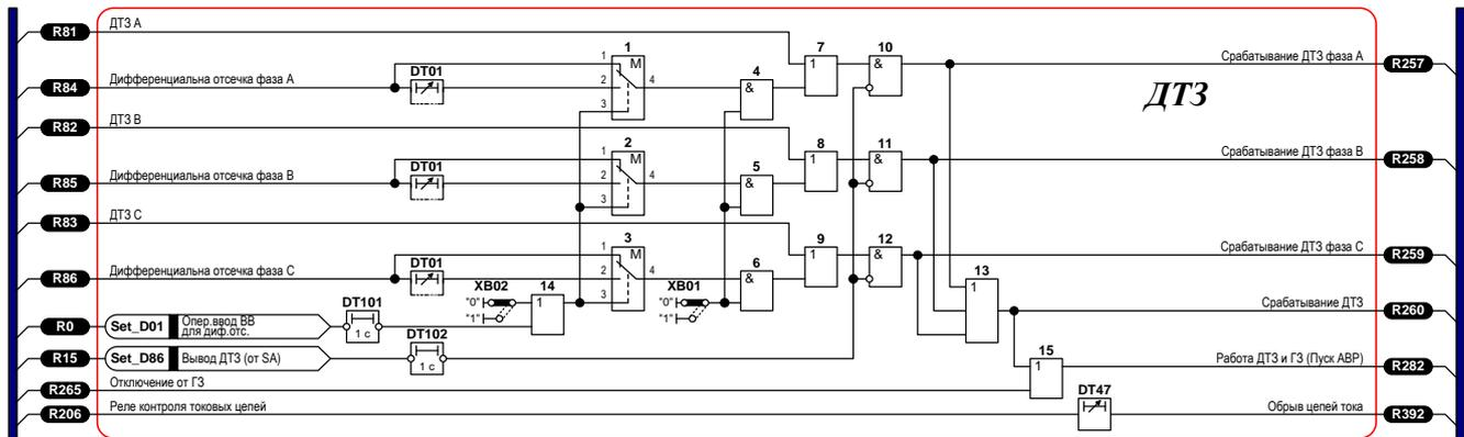
Рисунок 1 – Функциональная логическая схема блока логики ДТЗ
